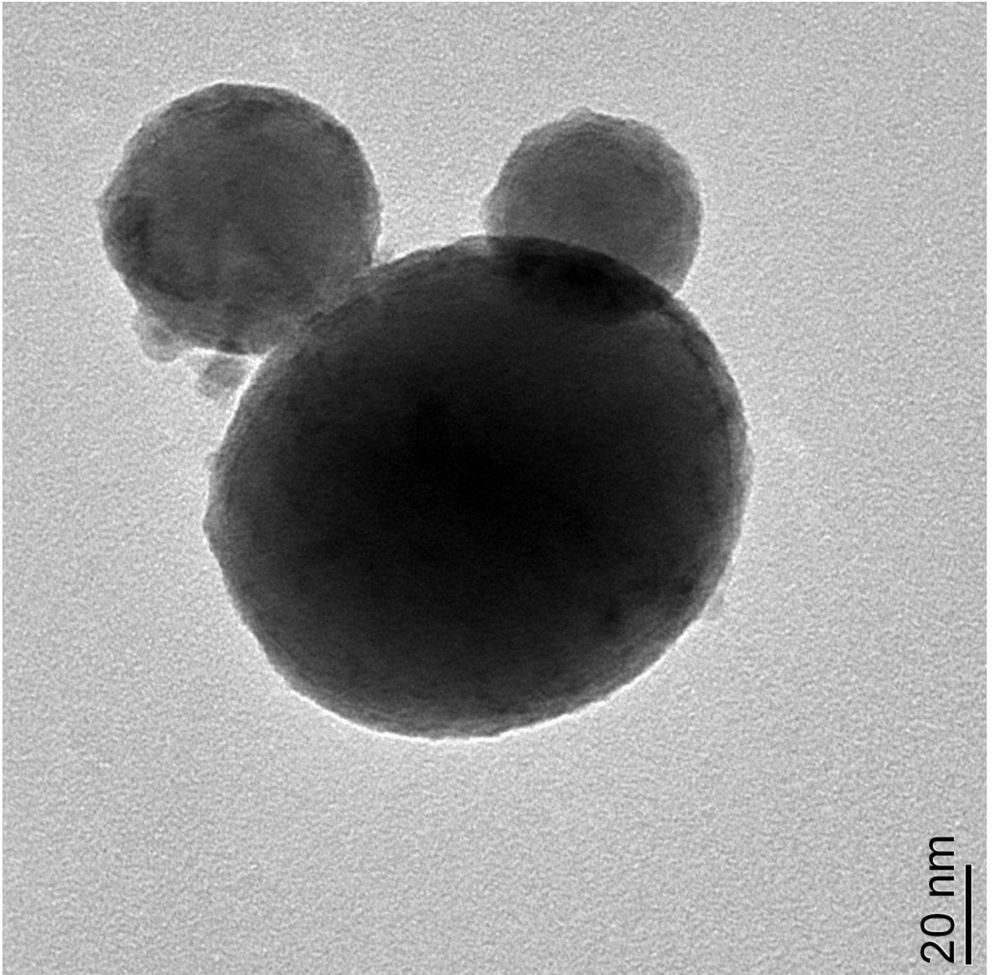
Image réalisée sur le MET CM120 de nanoparticules d'oxyde de fer
