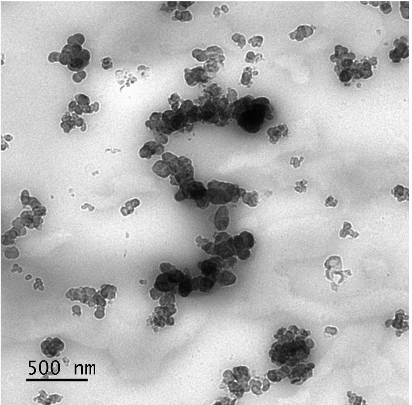
Répartition de noir de carbone au sein d'un thermoplastique vulcanisé PP/EPDM
