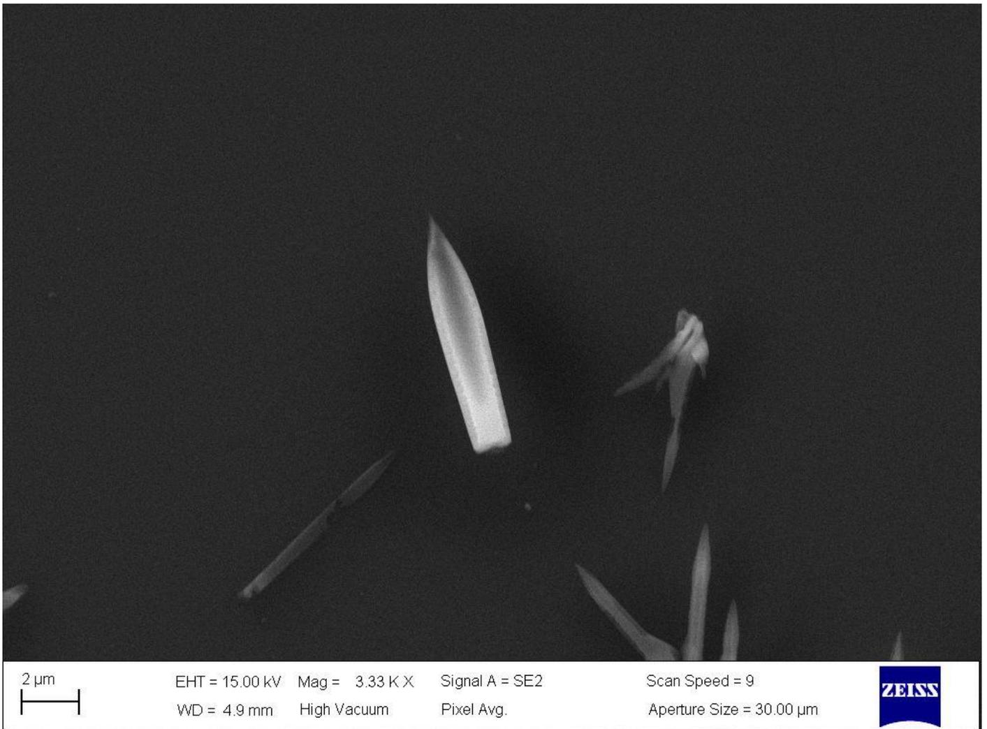
Image MEB d'un dépôt de bore sur Silicium
