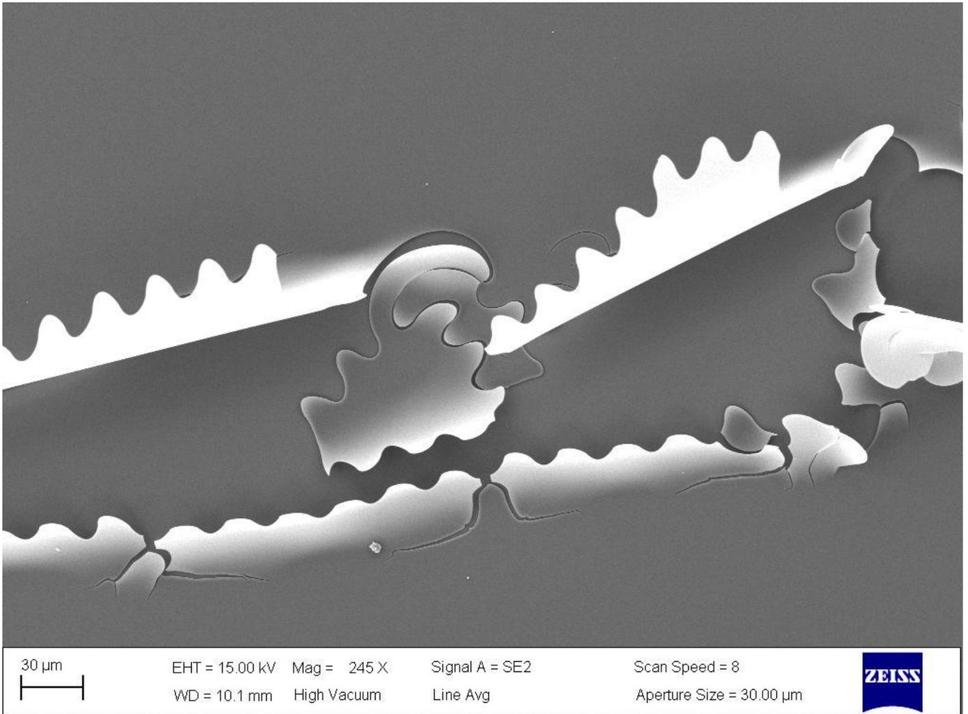
Image MEB d'un film de TiO<sub>2</sub> sur wafer de Si
